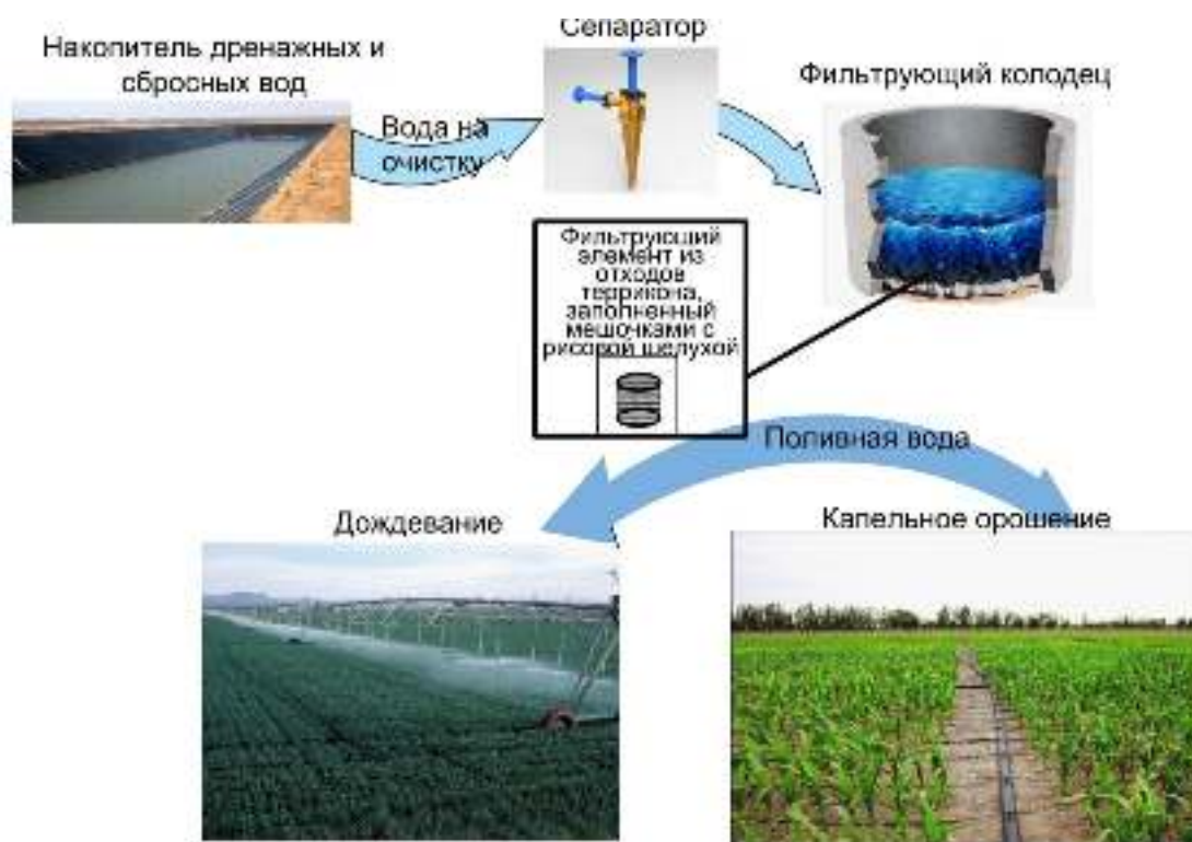
Рисунок 11 – Технология очистки дренажных и сбросных вод для сельскохозяйственного использования
