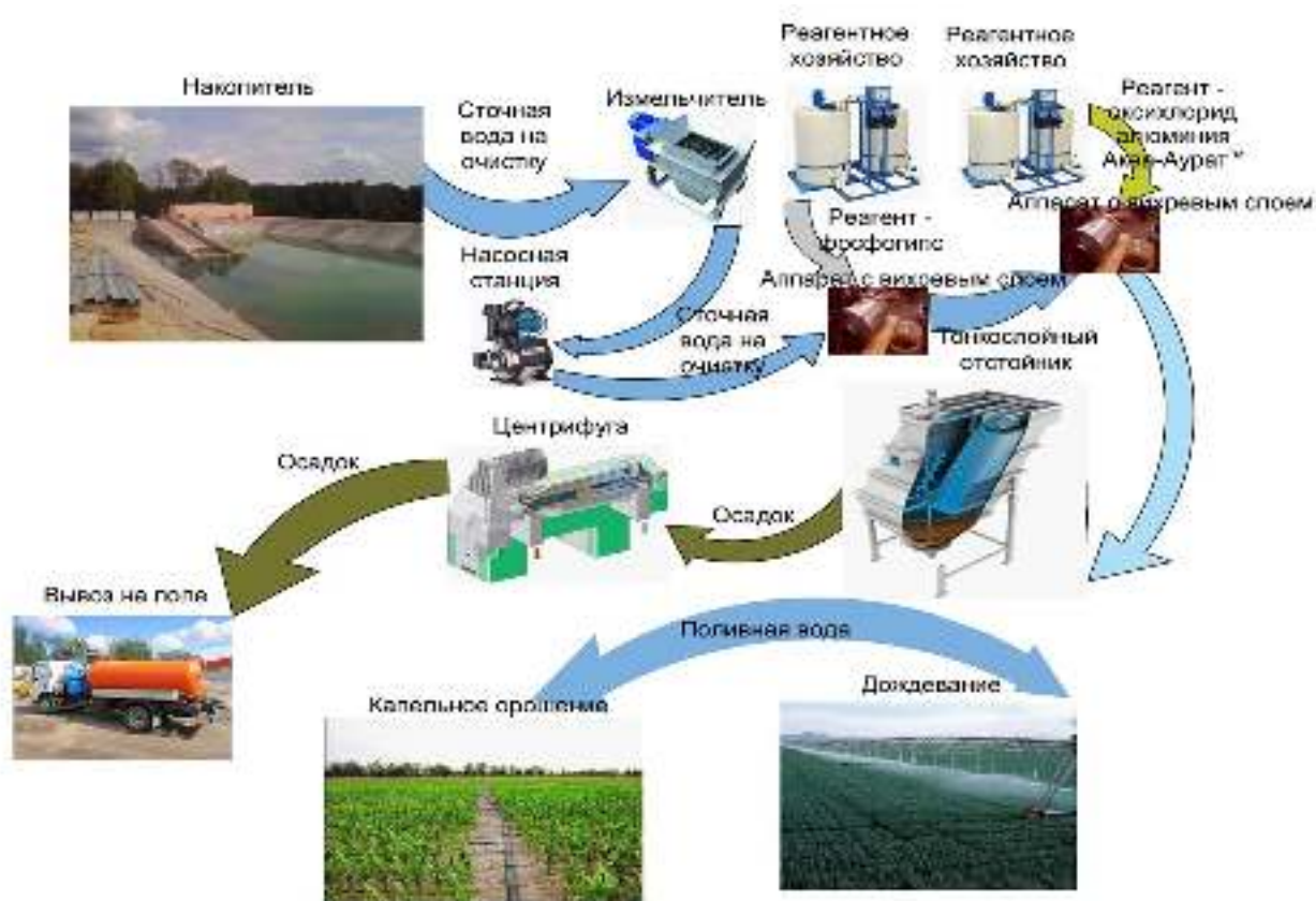
Рисунок 7 – Усовершенствованная технологическая схема подготовки животноводческих стоков для сельскохозяйственного использования с применением оксихлоридного коагулянта
