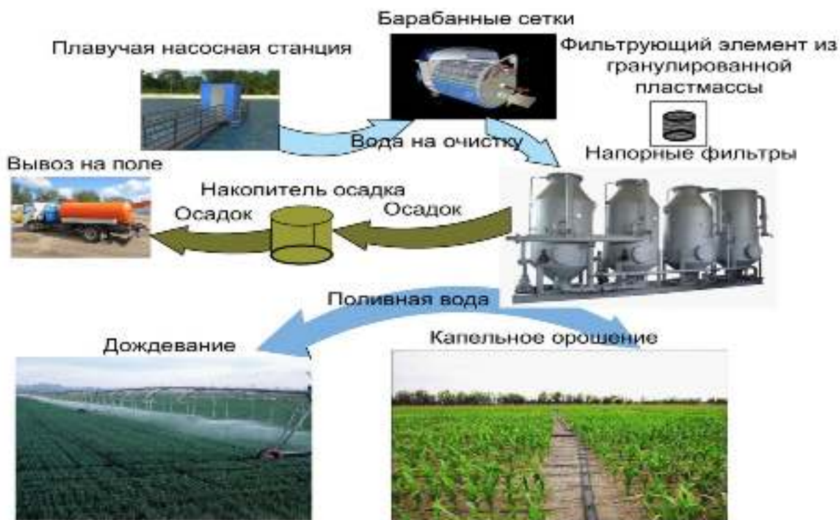
Рисунок 4 – Технологическая схема очистки природных вод для целей орошения
