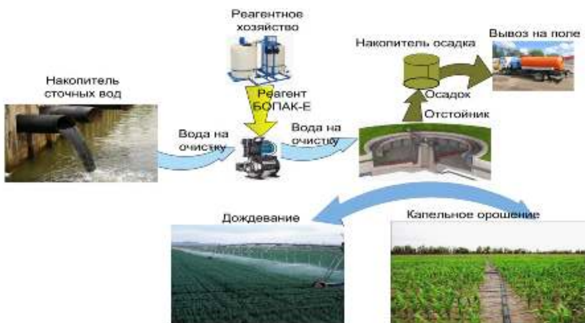
Рисунок 8 – Технология подготовки животноводческих сточных вод крупного рогатого скота для сельскохозяйственного использования
